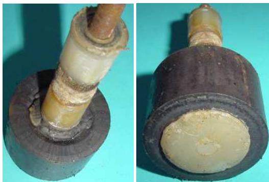
Bild 1.9: Welle mit Kunststoff in der Polradbohrung eingespritzt
