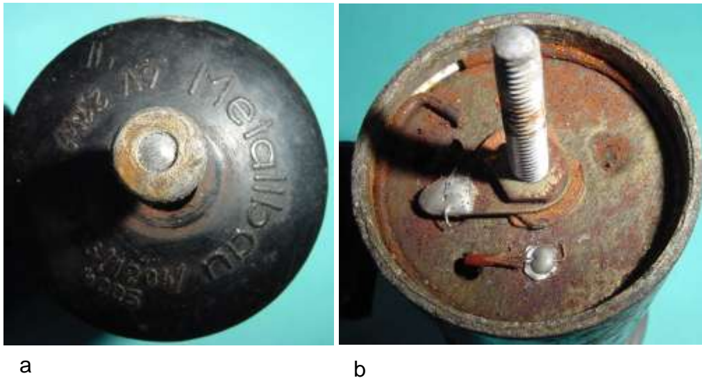
Bild 3.5: Boden: a) Boden mit der Beschriftung: Metallbau, 6 V; 2,1 W und 36/1204/4004, b) Montageplatte mit Drahtfeder in einer Nut des Gehäuses
