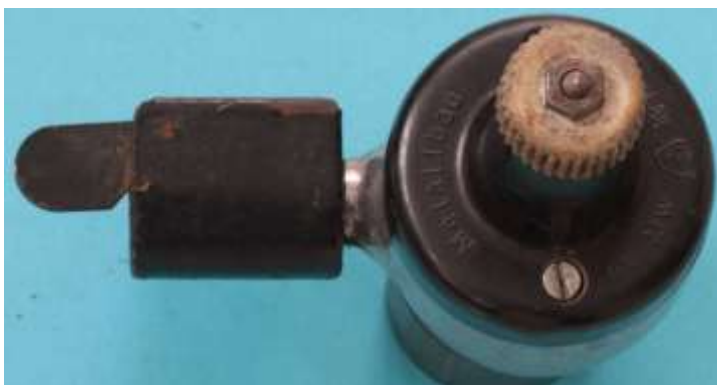
Bild 2.2: Blick auf das Reibrad und den Lagerhalsfuß
