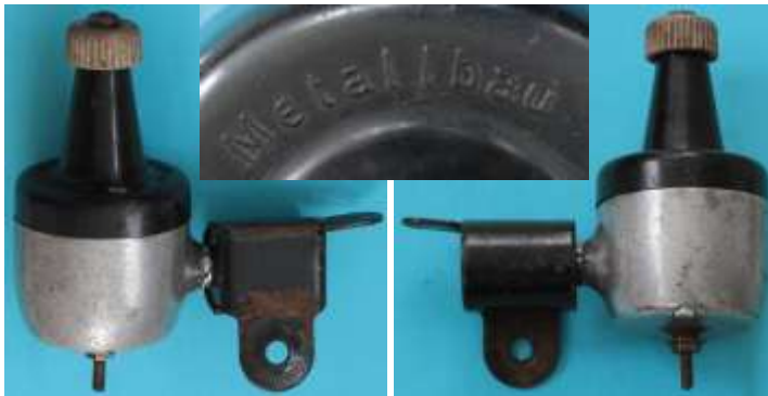
Bild 2.1: Dynamo 36/378/4005 der Firma Metallbau, Radebeul
