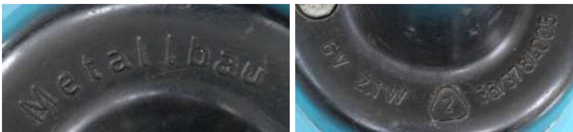
Bild 2.3: Beschriftung des Lagerhalses: a) Firmenname: Metallbau, b) Nenndaten: 6 V; 2,1 W, Gütezeichen 2, Zahlenreihenfolge: 36/378/4005
