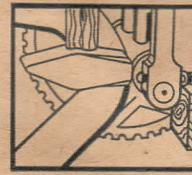
Nach demontierter Kurbel ist der Keil mit einem kräftigen Hammerschlag zu befestigen. Durch Festdrehen der Mutter M 6 wird die Sicherung erreicht, um Schläden an der Getriebewelle (Eindrücke) zu vermeiden.
